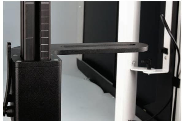
Agilidad en la manipulación del soporte de sujeción de la cámara: simplemente presione y mueva. Sin tornillos de fijación.
