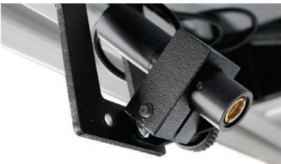
2 punteros láser lineales para adecuar el posicionamiento de objetos. Su alta potencia, dentro de los límites de seguridad (LÁSER CLASE 2M), garantiza la visibilidad de los haces de láser incluso con las luces a máxima intensidad. Pueden activarse a través del software o mediante por los botones del hardware de ALPHASHOT.
